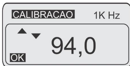
Figura 22 – Nova calibração inicial do microfone – permite ajuste
